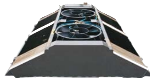
Module de refroidissement « sous plafond » pour le Train AGC avec faisceau cuivre/laiton pour basse et haute température de fonctionnement et haute performance de ventilation.
